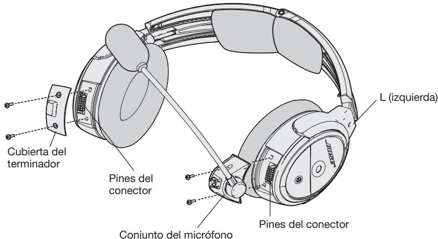
**Precaución:** No fuerce el conector en el enchufe o puede dañar el casco.
